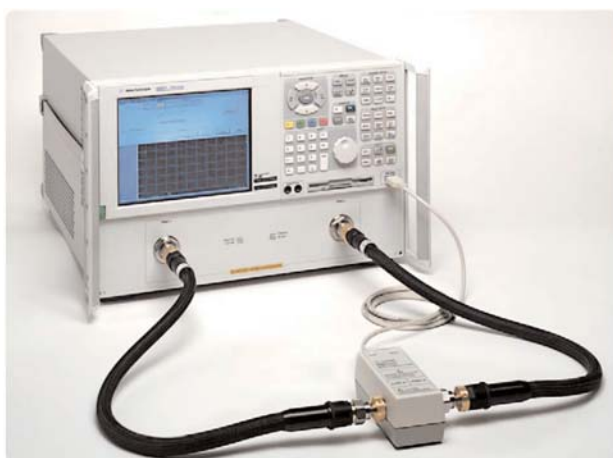
Типичное время 2-портовой калибровки с 1601 точкой и полосой ПЧ 35 кГц составляет менее 9 секунд.
