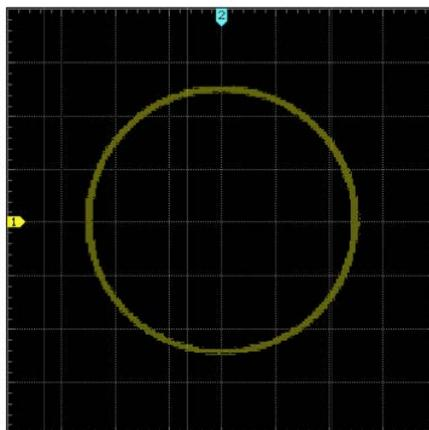
4. Согласно рисунку расстояние от пересечения кругом оси X и оси Y до начала координат приблизительно равно. Тем самым мы получили угол разности фаз равный  $\theta = \pm \arcsin 1 = 90^\circ$ .
