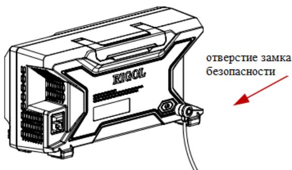
Рис. 1-12 Использование замка безопасности
