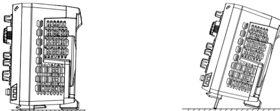
Рис. 1-3 Регулировка опорных ножек
