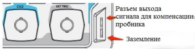
Рис. 1-6 Использование сигнала компенсации
