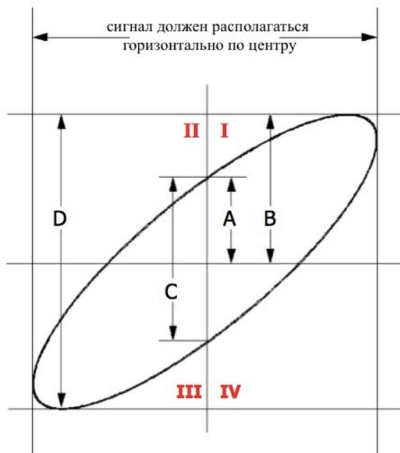
Согласно  $\sin\theta=A/B$  или  $C/D$ , где  $\theta$  это угол разности фаз между каналами, а значения  $A, B, C, D$  указаны на рисунке сверху. Из этого можно получить угол разности фаз:
