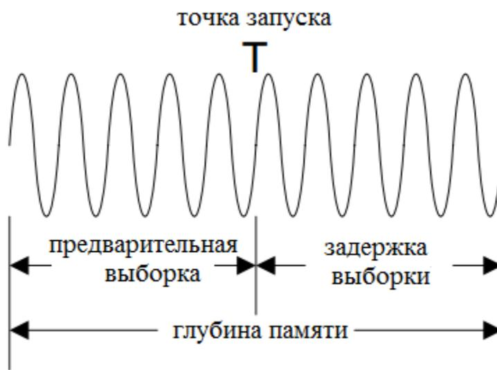
Связь глубины памяти, частоты выборки и длины сигнала представлена следующей формулой:
