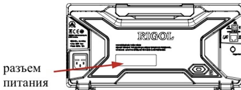
Рис. 1-4 Подключение источника питания
