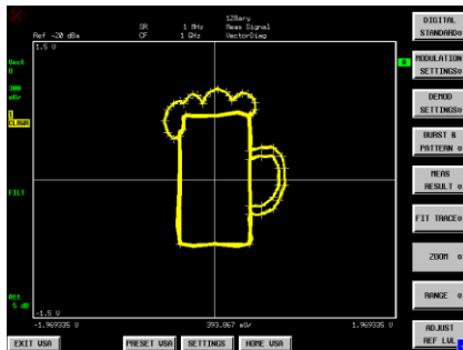
Рисунок 1-17 – I/Q-диаграмма сигнала, сформированного векторным генератором сигналов
