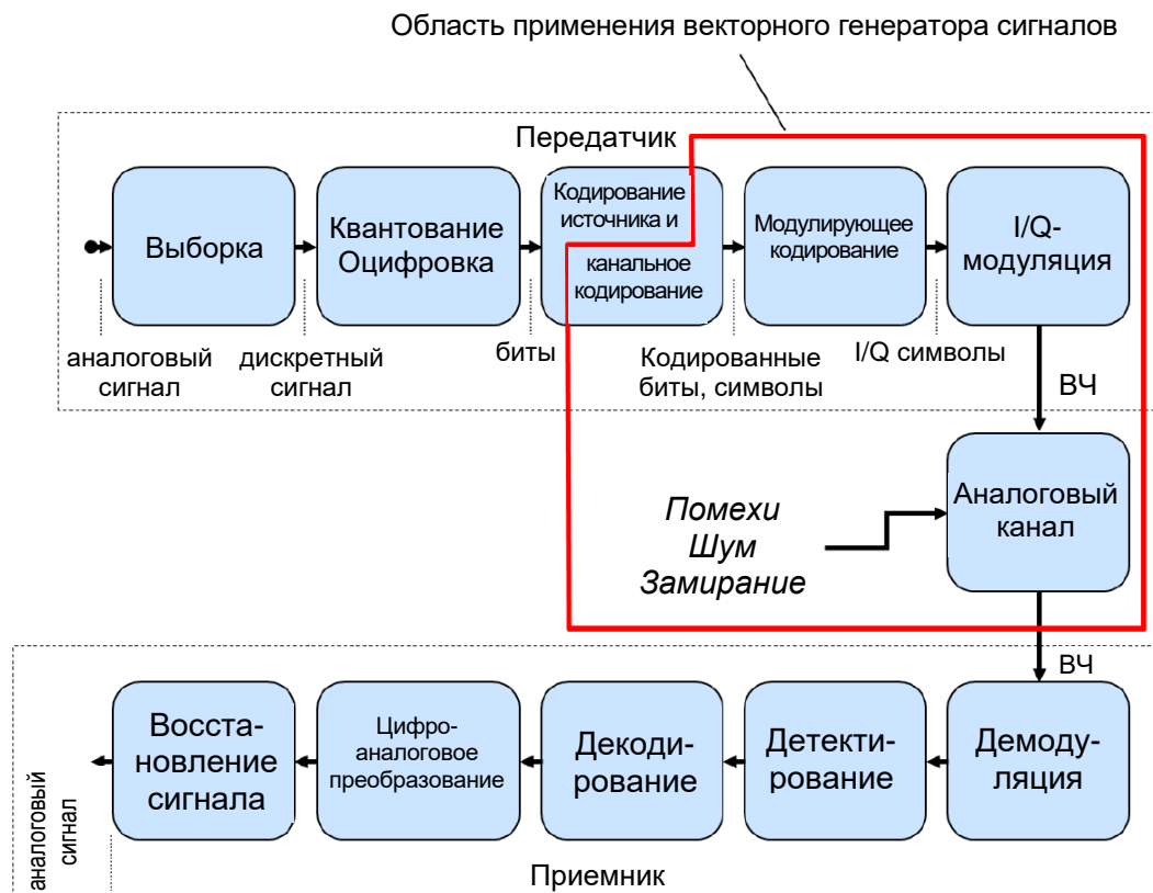
Рисунок 1-18 – Цифровая передача данных (речь, данные) с указанием области применения векторных генераторов сигналов
