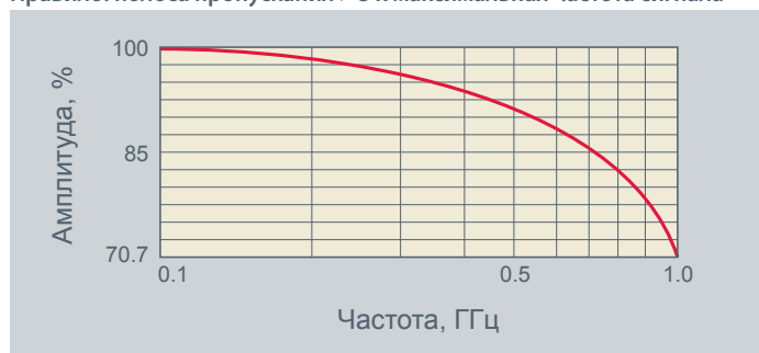
Рис. 1. Типовая амплитудно-частотная характеристика осциллографа общего назначения
