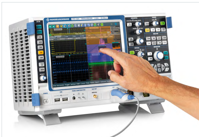
Сенсорный экран с высоким разрешением обеспечивает ритмичность работы. Функция SmartGrid от компании Rohde & Schwarz обеспечивает возможность гибкого размещения осциллограмм путем перетаскивания
