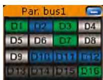
Состояние сигналов цифровых каналов отображается на пиктограммах сигналов вне зависимости от настроек осциллографа
