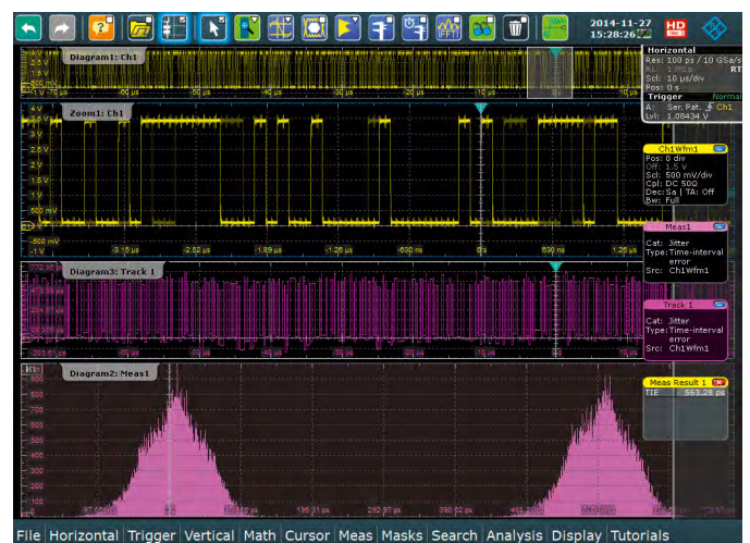
Измерение искажения временного интервала (TIE) внутреннего тактового сигнала для различных битовых последовательностей (010000X10000001). На нижней гистограмме видно, что TIE отличается от параметра, полученного из битовой последовательности
