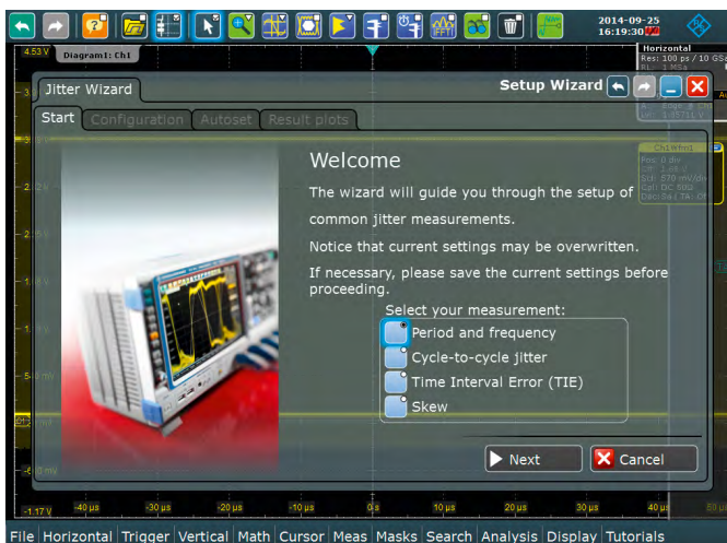
Мастер измерения джиттера Jitter wizard, обеспечивающие простую и быструю настройку измерений джиттера
