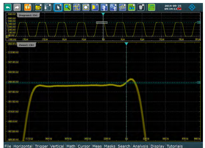
Уникальная архитектура цифровой системы запуска позволяет добиваться стабильной синхронизации, даже по таким элементам сигнала, как показанный здесь 0,4 % выброс (опция высокой четкости)
