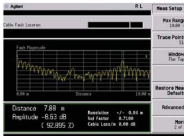
Вычисление расстояния до места повреждения в кабеле
