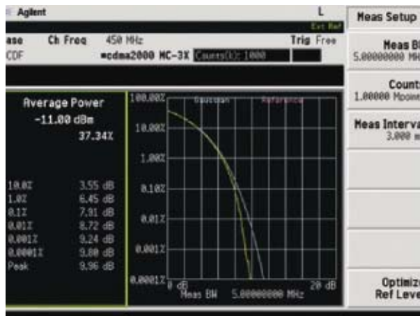
Измерение дополняющей интегральной функции распределения сигнала cdma2000 с четырьмя несущими
