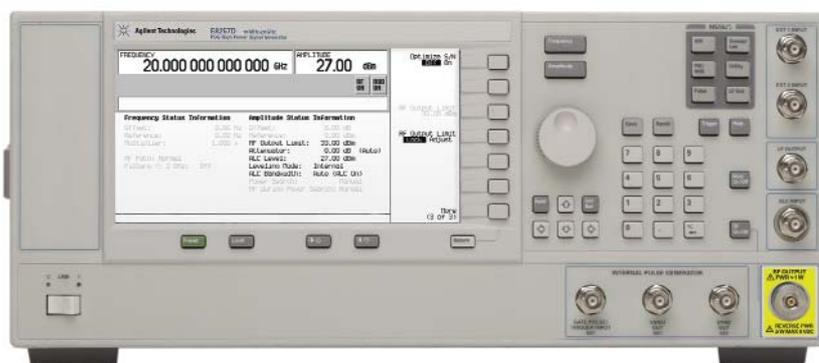
Генератор сигналов E8257D компании Agilent - генератор полностью синтезированных сигналов с высокой выходной мощностью, низким уровнем фазового шума и дополнительной возможностью плавного (аналогового) свипирования.
