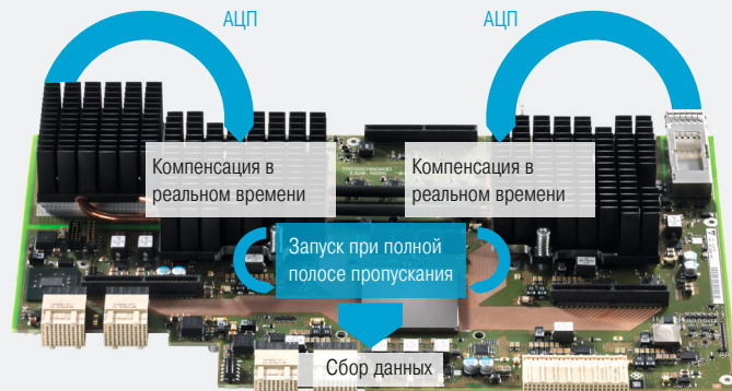
Плата запуска и компенсации цепей в реальном масштабе времени осциллографа R&S®RTP
