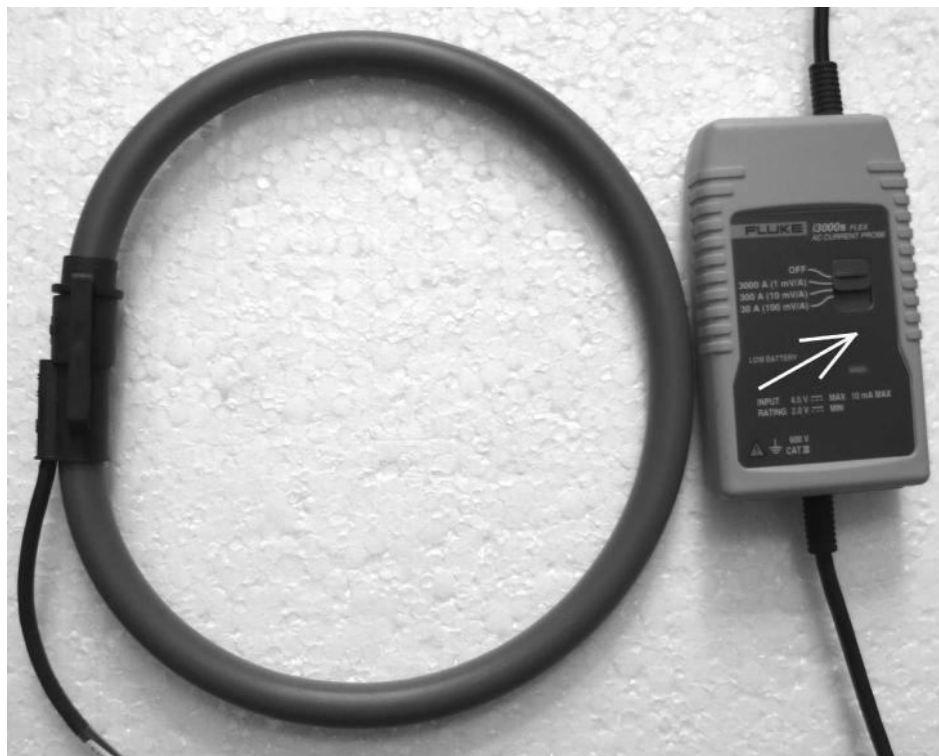
Рисунок 2 - Внешний вид поясов моделей i3000s Flex, Fluke i3000s Flex-24, Fluke i3000s Flex-36, стрелкой показано место нанесения знака утверждения типа.
