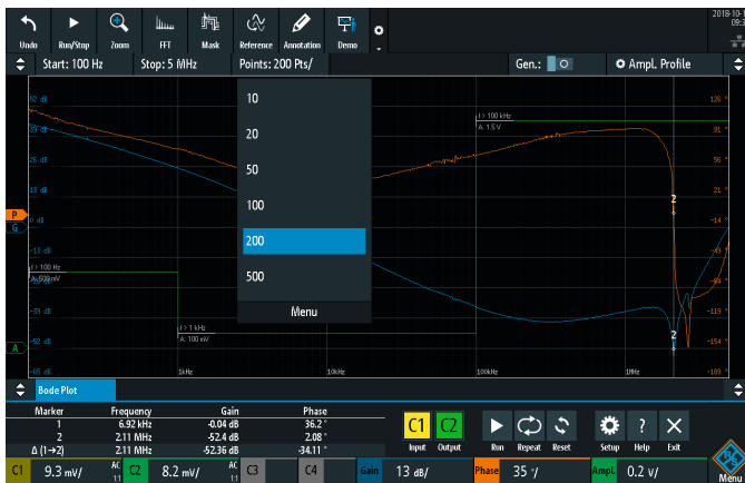
Разрешение измерения может варьироваться за счет изменения количества точек на декаду
