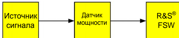
Рис. 6-2 – Датчик мощности: стандартная схема измерения
