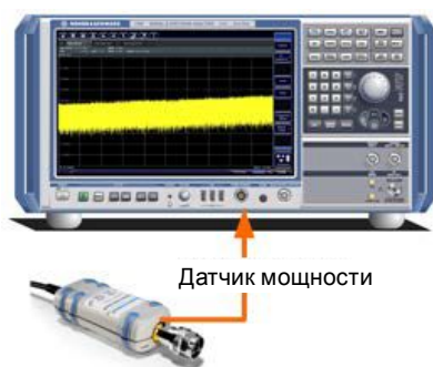
Рис. 6-3 – Подключение датчика мощности с использованием интерфейса POWER SENSOR
