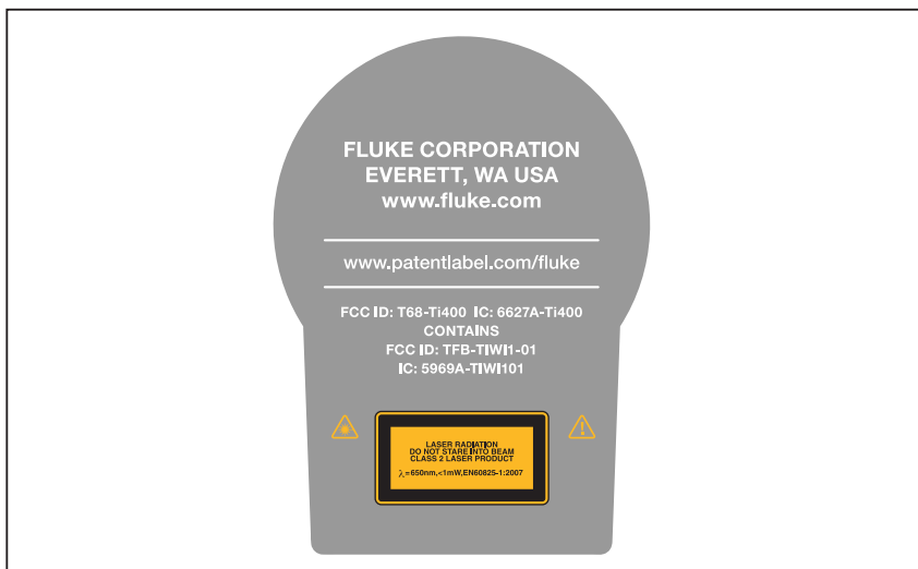
Рисунок 1. Дополнительное предупреждение относительно лазерного излучения на крышке объектива
